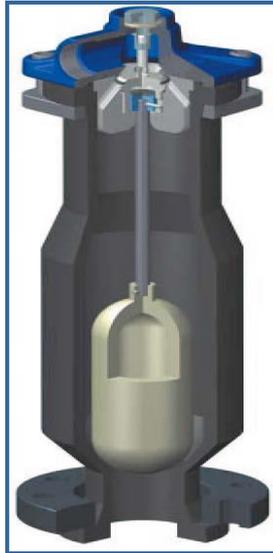
**Fig VIII. 1 image d'une ventouse hydraulique**
