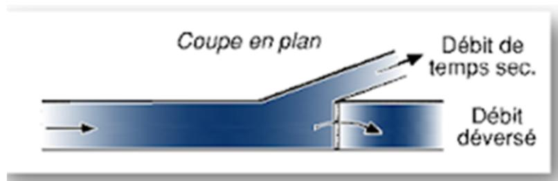
**Figure VI.7** — Déversoir d'orage à seuil frontal (coupe en plan)
