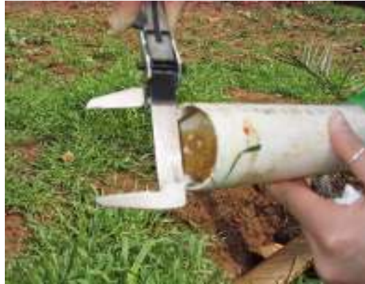
Figure III.7 : mesure du diamètre intérieur de la conduite avec le pied à coulisse
