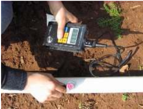
Figure III.17 : positionner la sonde sur la conduite d'une façon Perpendiculaire
