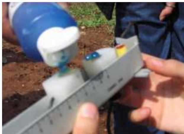
Figure III.8 : Mettre une noisette de gel sur les deux sondes
