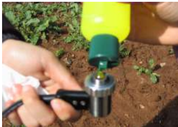
Figure III.16 : appliquer le couplant (Gel) sur la face de la sonde
