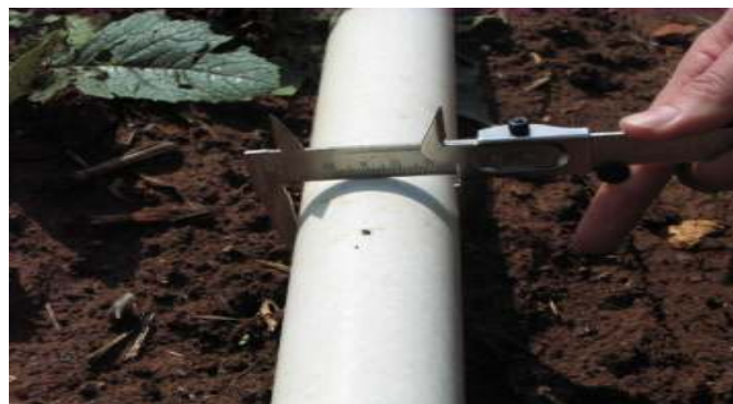
Figure III.6 : mesure du diamètre extérieur de la conduite avec le pied à coulisse
