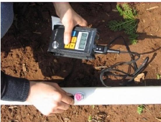
**Figure.20** : positionner la sonde sur la conduite d'une façon parallèle
