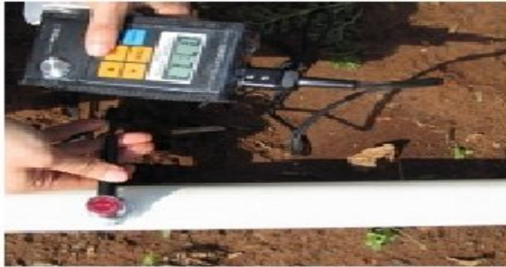
**Figure.14 :** Mesure du diamètre intérieur de la conduite avec la sonde d'épaisseur.
