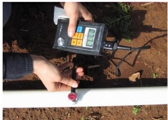
**Figure.21** : positionner la sonde sur la conduite d'une façon Perpendiculaire
