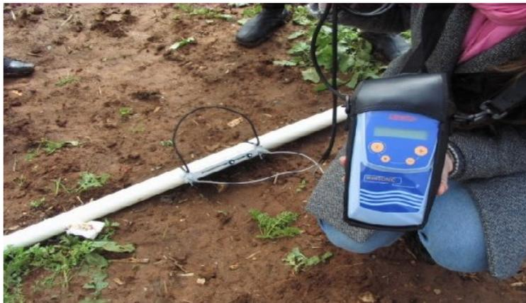
**Figure.18** : Raccordement du débitmètre avec la sonde
