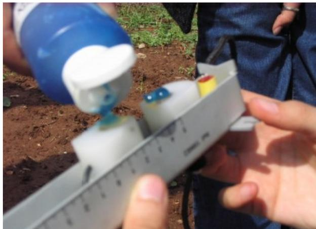
**Figure.15 :** Mettre une noisette de gel sur les deux sondes
