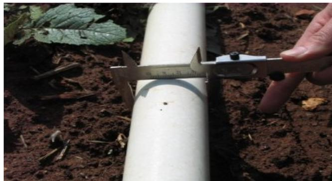
**Figure.12** : Mesure du diamètre extérieur de la conduite avec le pied à coulisse.
