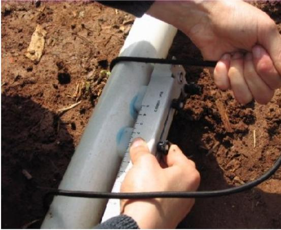
**Figure.16** : Raccordement des sondes
