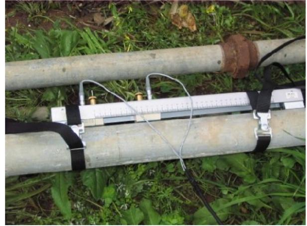
**Figure.17** : Raccordement des sondes
