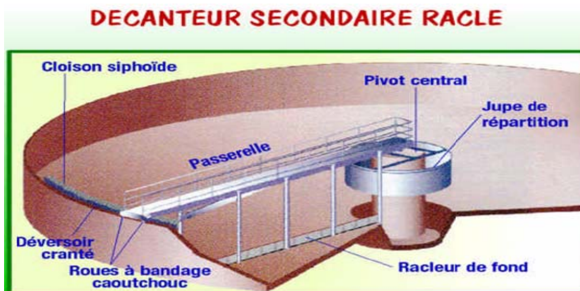
Figure II-05 : Décanteur primaire et secondaire
