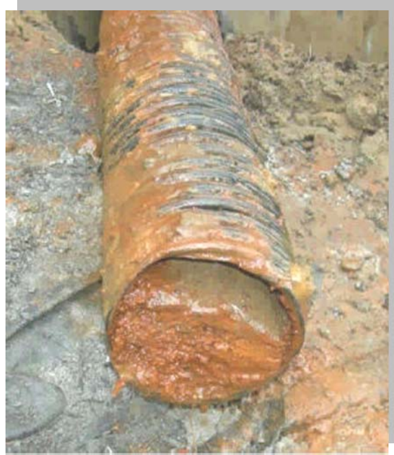
Figure VIII-1 : colmatage ferrique des orifices d'un drain
