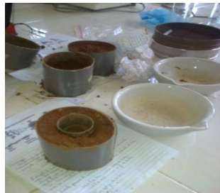
Fig.3 Préparations des cylindres pour la mesure de la densité apparente. La densité réelle a été mesurée au laboratoire à l'aide de la méthode des éprouvettes.
