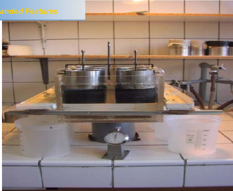
Fig.5 Dispositif pour l'expérience de Henin.
