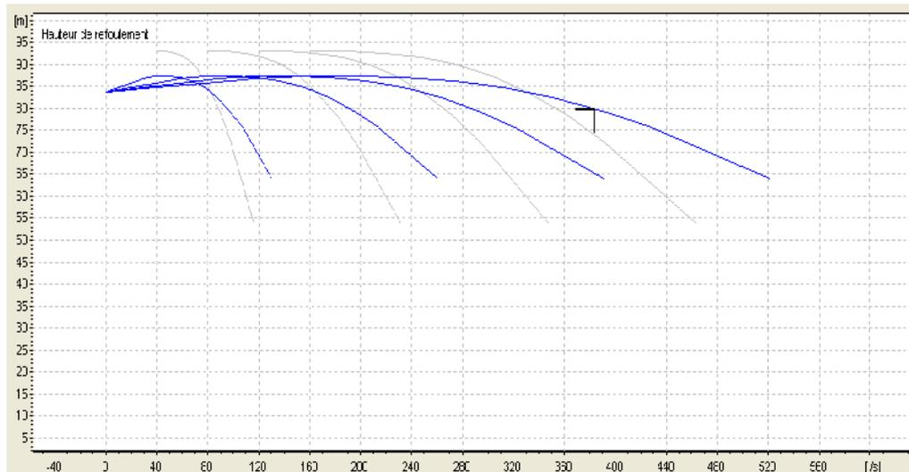
Figure III .1 les Courbes caractéristique de la pompe. [7]
