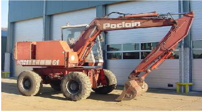
Figure V-2: Pelle équipée en rétro
