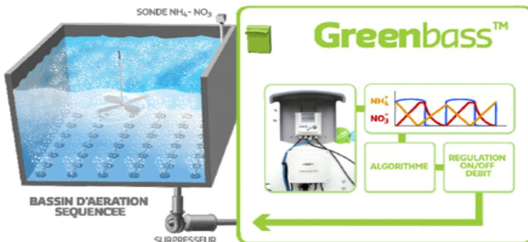
Figure IV.3 : Schéma explicatif du système Greenbass.
