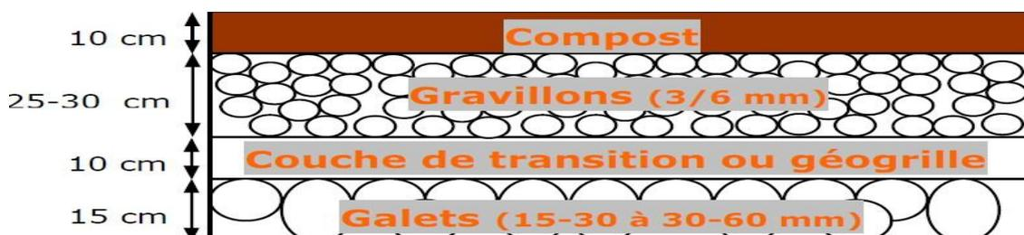
Figure IV.8 : Constitution du massif d'un lit de séchage planté de roseaux.
