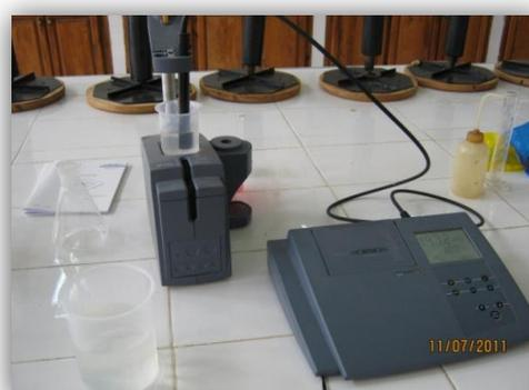
Fig IV.37: Mesure de la conductivité électrique.
