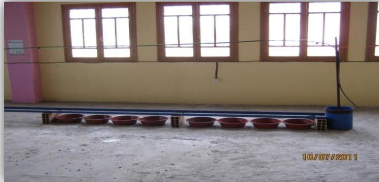
**Fig IV.1 :** Bassines recueillant les eaux drainées et un tuyau d'arrosage.
