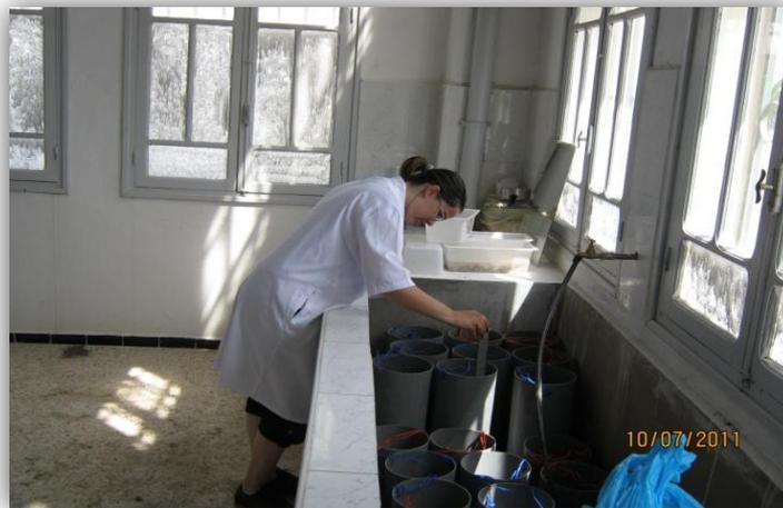
**Fig IV.6 :** Remplissage des colonnes par de la terre.
