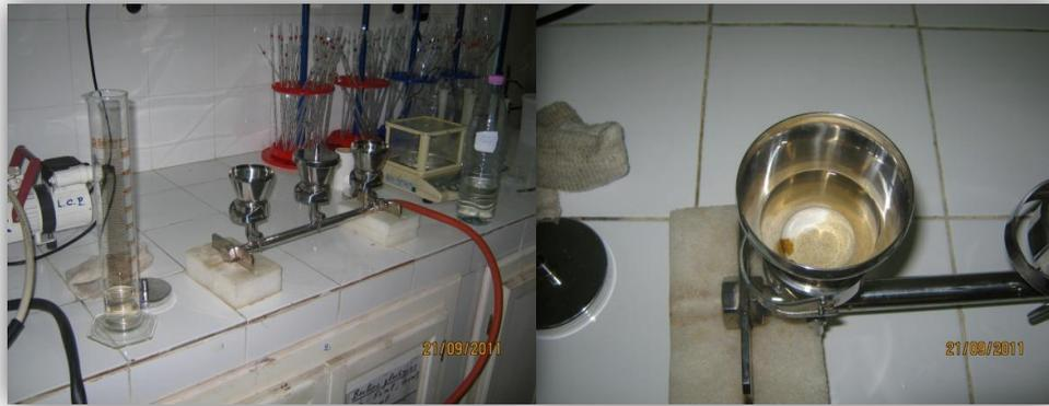
**Fig IV.38 :** Mesure des MES par filtration.
