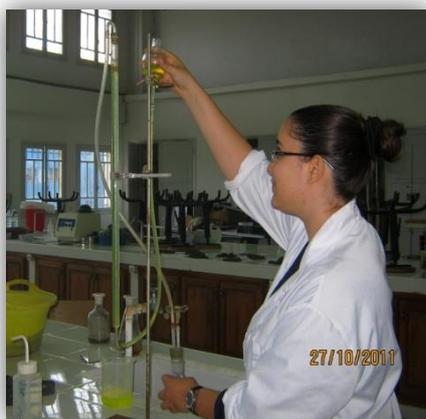
Fig IV.35 : Mesure du calcaire total à l'aide du calcimètre de Bernard.
