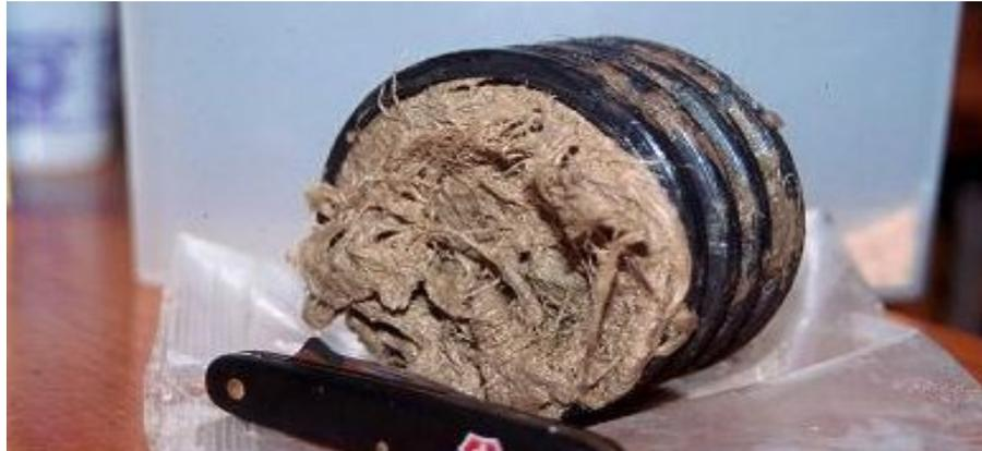
D'après l'image en dessus on constate que ce problème et permettre de boucher les drains et stoppera le passage de l'eau vers le collecteur.
