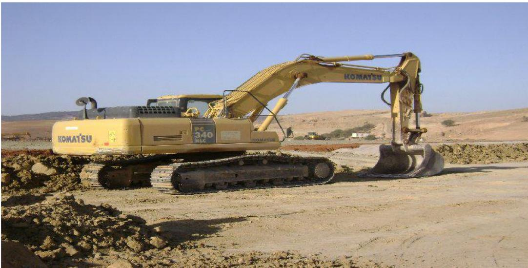
**Figure 7.1.** Pelle à chenille avec godet à position rétro
