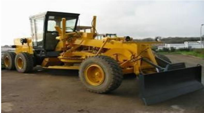
**Figure VIII.7 :** Niveleuse automotrice
