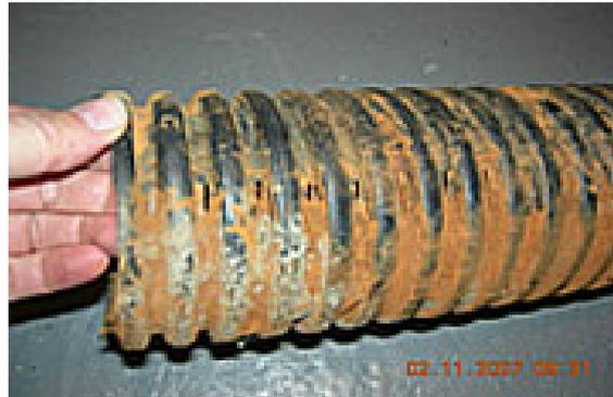
**Fig. VIII.4: Colmatage ferrique des orifices d'un drain**
