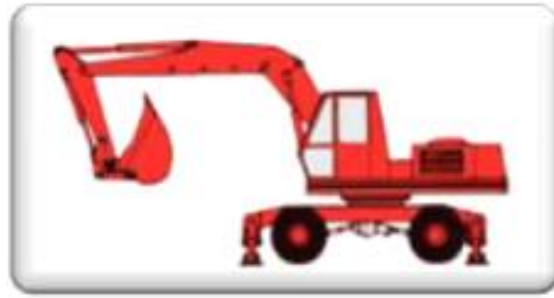
Figure VIII-2 : Pelle sur pneus, avec godet en rétro.
