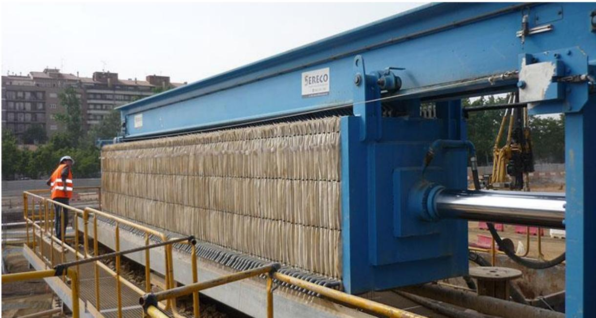
**Figure IV.8 :** Filtres sous-pression.
