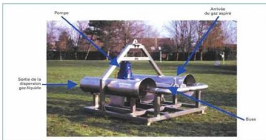
**Figure III.5 :** Ventoxal d'Air Liquide
