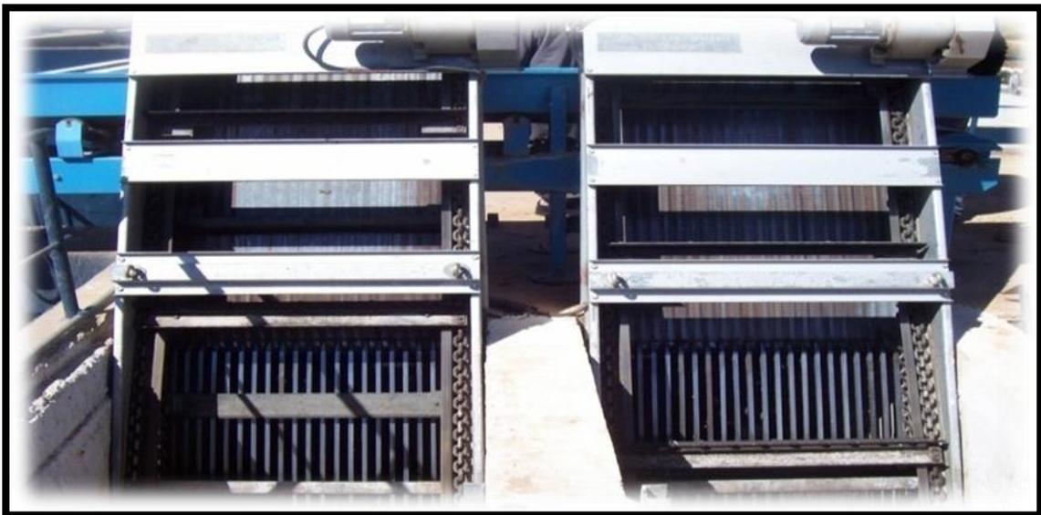
**Figure II.3:** grille mécanique.
