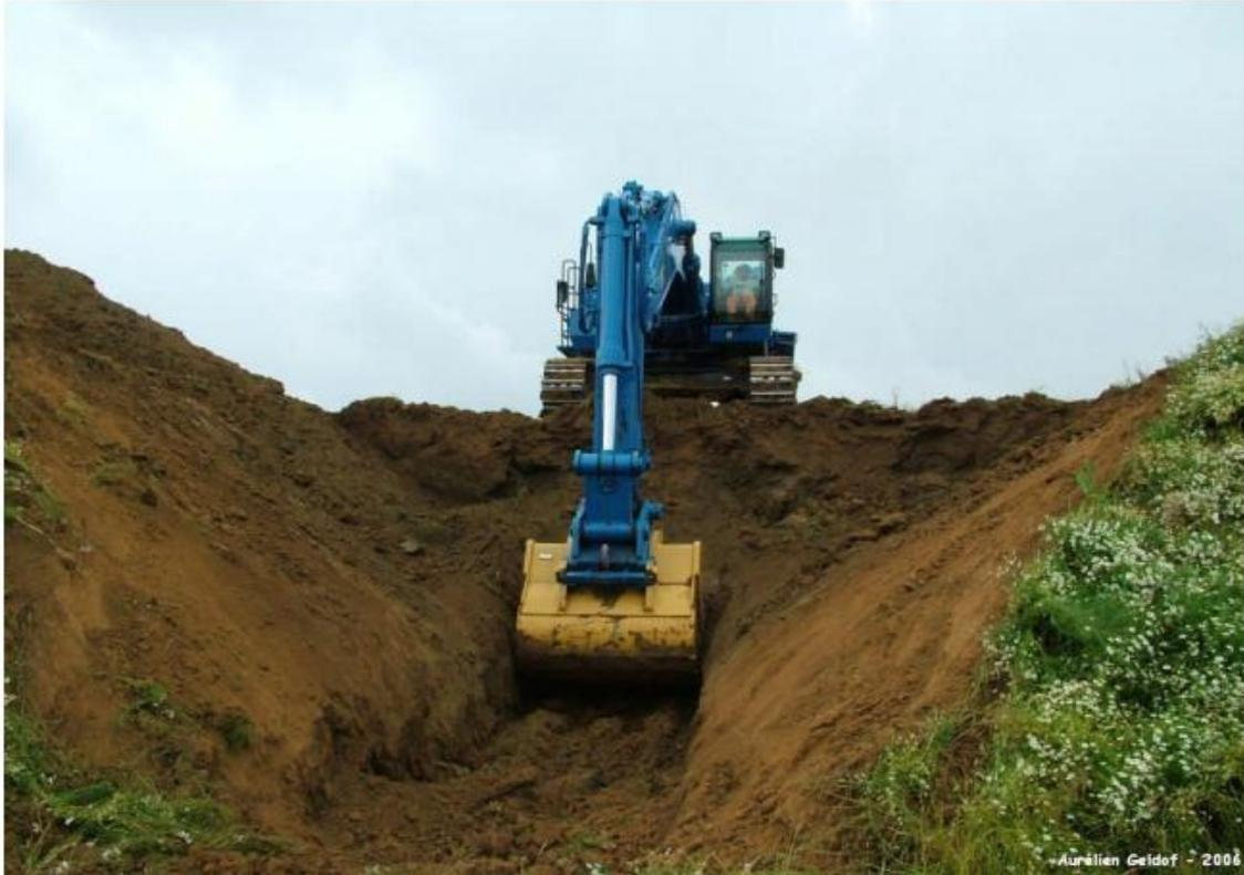
**Figure 1: Pelle hydraulique.**
