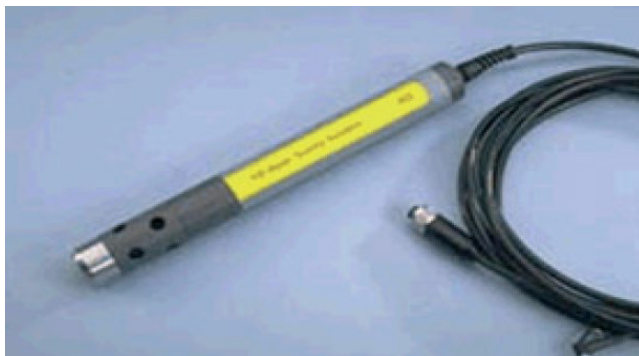
Figure III.4 Sonde YSI 600 XL (multi paramètres : oxygène dissous, température, conductivité, salinité, pH...).
