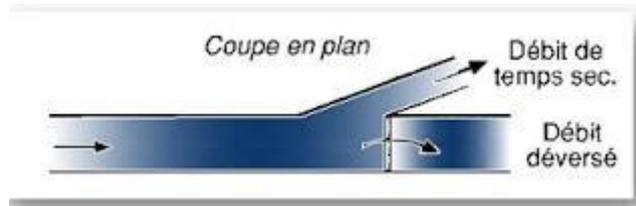
Figure VI .2Déversoir d'orage à seuil frontal (coupe en plan).
