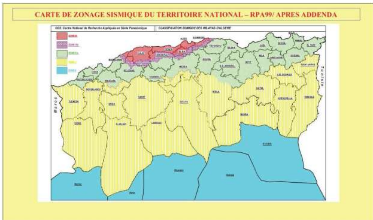
Figure I.4 : carte de zonage sismique en Algérie
