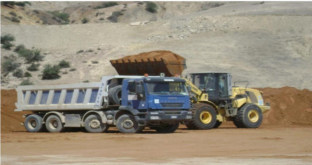
Figure VI.3 : Camions à benne et Charger
