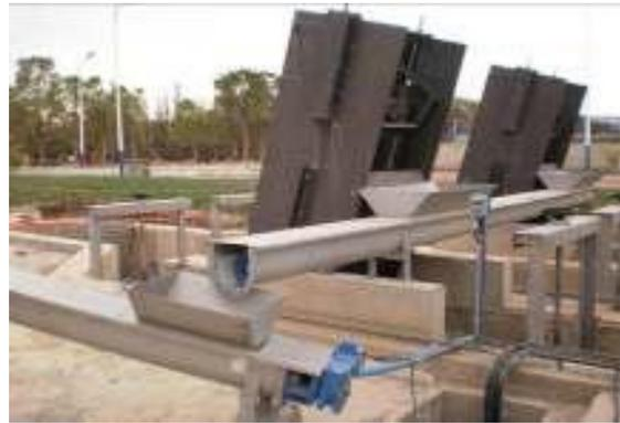
Figure II.2 : Dégrillage grossier + fins
