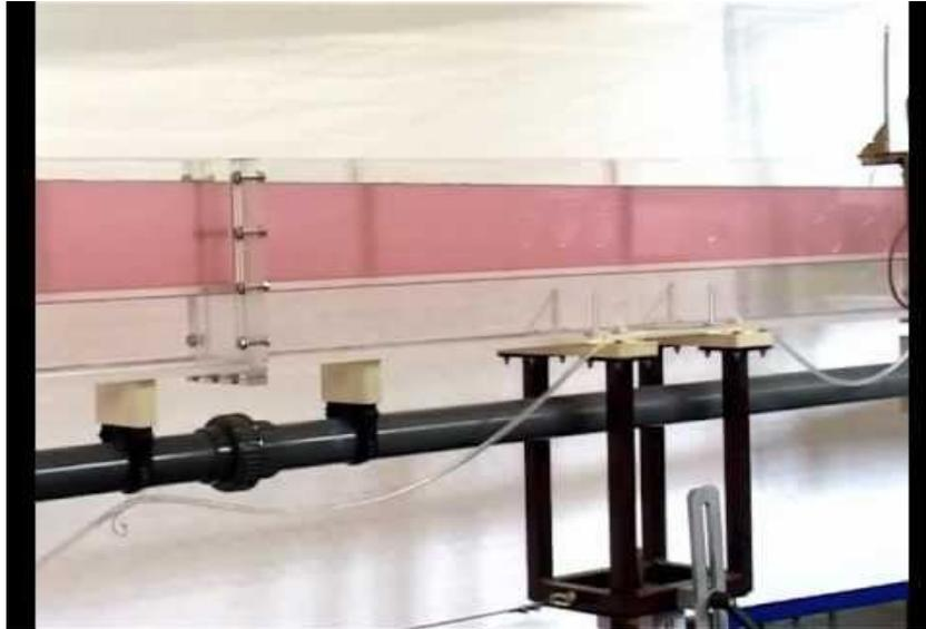
Figure III. 12 : Banc d'étude des courbes de remous à pente forte dans un canal à surface libre.
