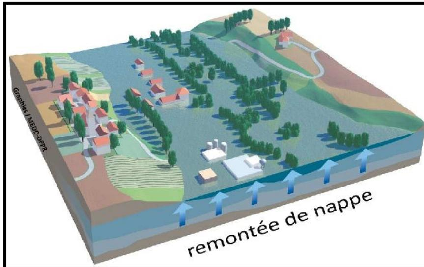
Figure I.7: Inondation par remontée de la nappe (BOUDJERDA M., 2005)
