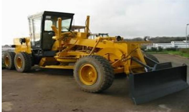
**Figure VII.5 :** Niveleuse automotrice
