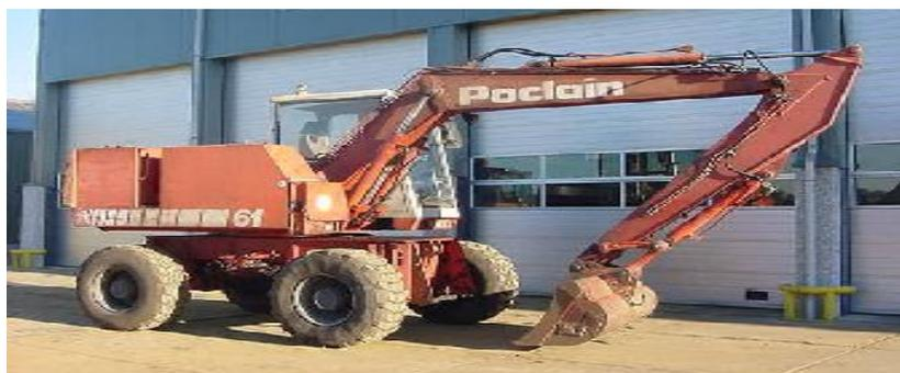
**Figure VII.6:** Pelle équipée en rétro
