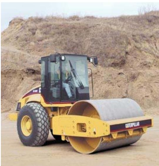
**Figure VIII.4** : Compacteur à cylindre et pneu
