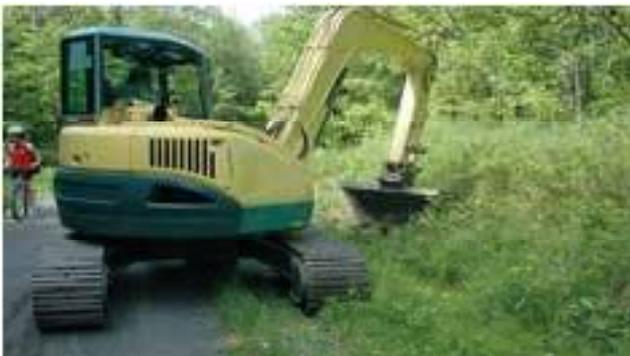
**Fig 36: Pelle hydraulique de petit gabarit**
