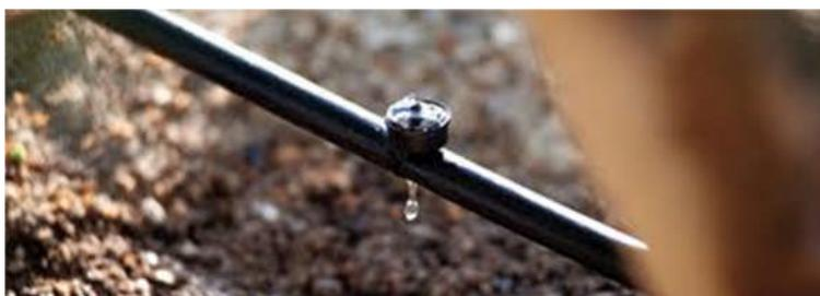
**Figure .IV.2 :** Porte rampe et un goutteur
