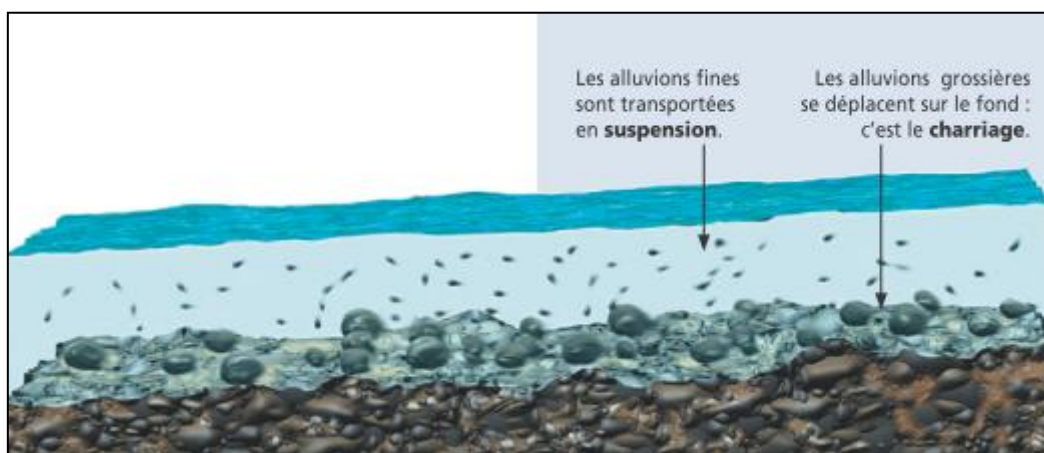
Figure .I.16. Procédés du transport solide.
