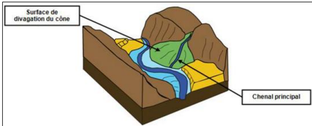
Figure I.4. Structure morphologique d'un cours d'eau torrentiel. (Source : AZI)
