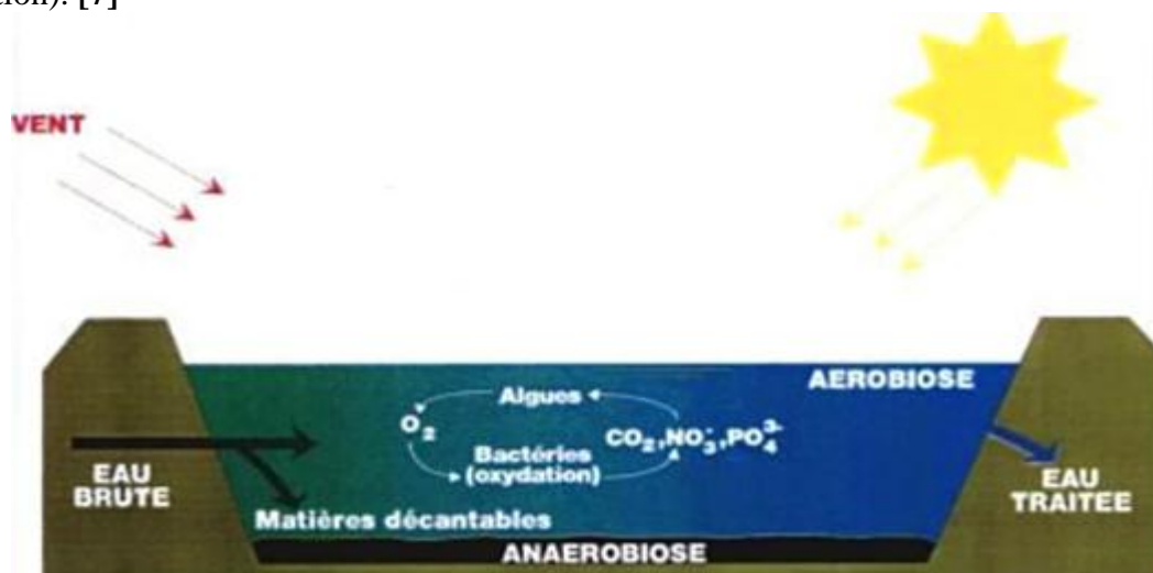
Figure 11 : Mécanisme de fonctionnement de lagunage naturel
