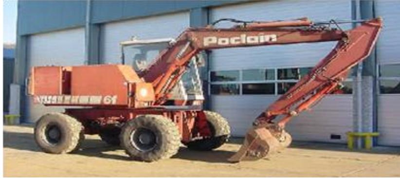
**Figure VIII.6 :** Pelle équipée en rétro
