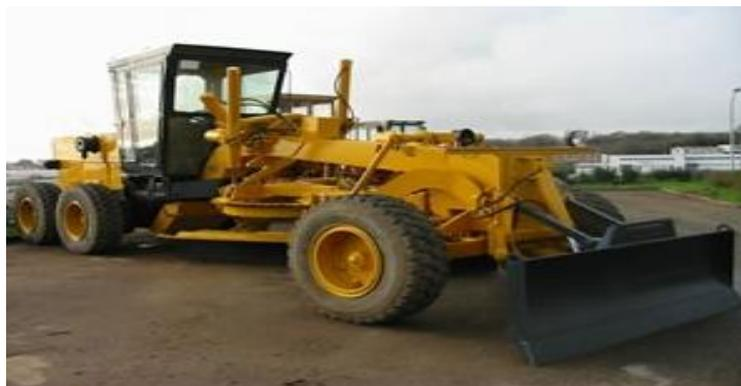
**Figure VII.6 :** Niveleuse automotrice source : (soidiki.centerblog.net)
