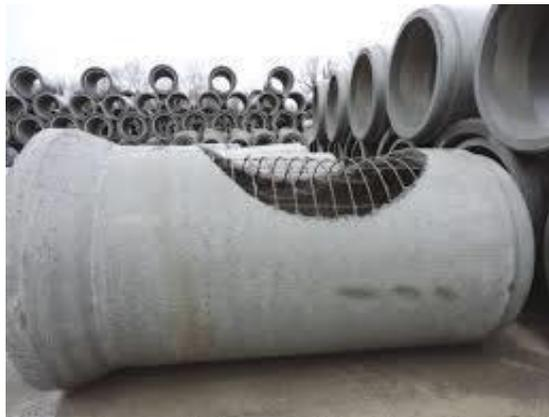
**Figure 15** : Les armature d'une conduite en béton armé *source (TUBERIAS Y PREFABRICADOS)*
