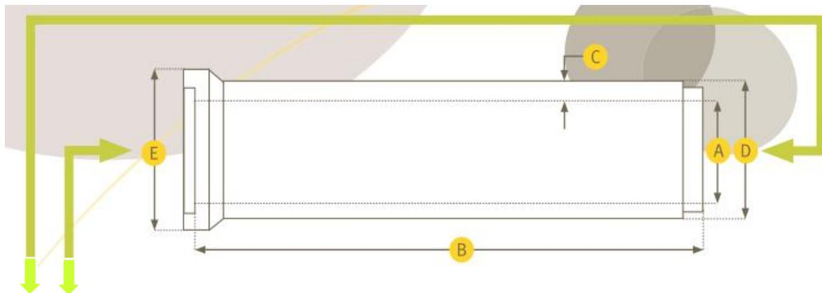
Figure 5: schéma descriptive des dimensions d’une conduite en béton armé série 135 A
