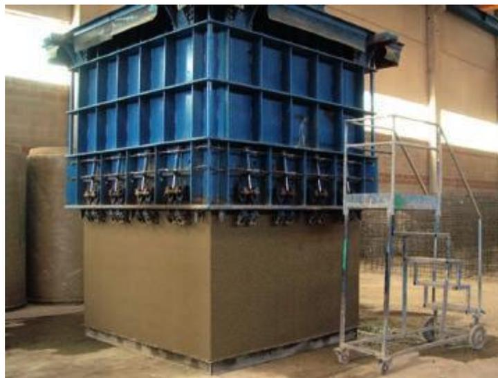
**Figure 7:** Fabrication d'un dalot en béton armé *source (TUBERIAS Y PREFABRICADOS)*
