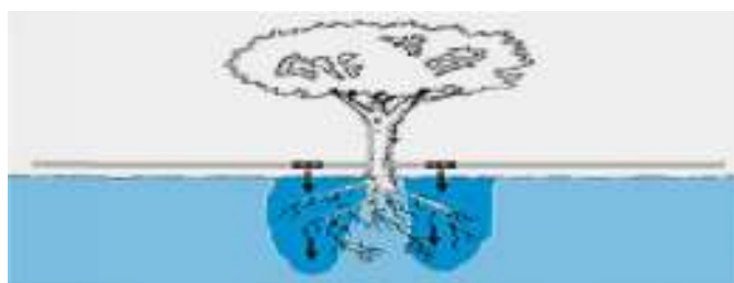
Figure VI. 5: zone humidifié par le goutteur
