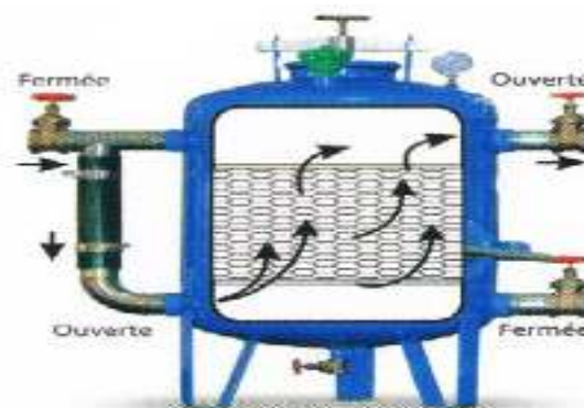
Figure VI. 15 : Filtre à gravier
