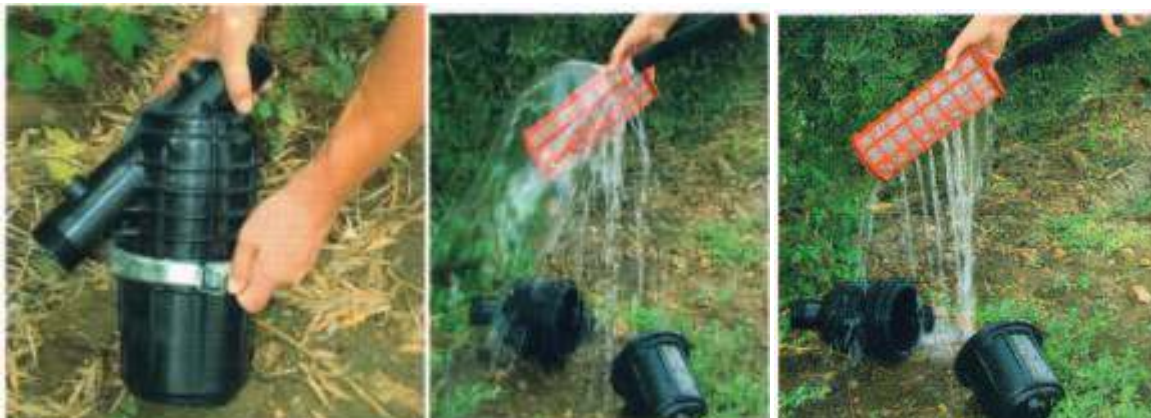
Figure VI. 16: Nettoyage filtre à tamis
