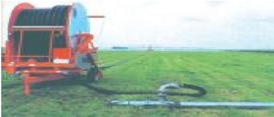
**Figure III.1. Arroseur automoteur**
