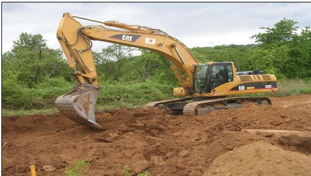
**Figure V.1 :** pelle à chenilles avec godet à position rétro.
