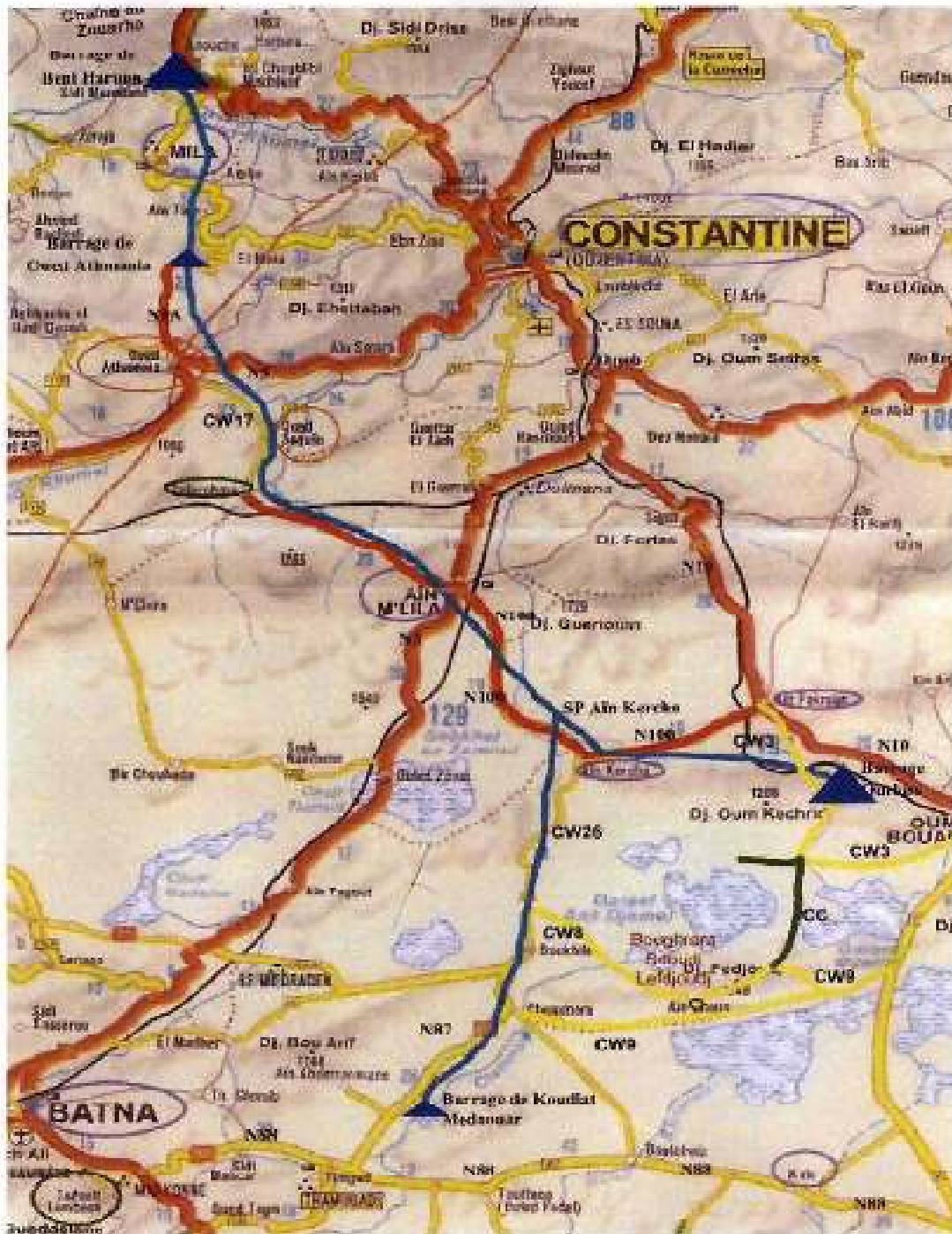
Source : APD transfert à partir du Barrage Athmania Schéma du transfert de Beni-Haroun vers le périmètre de BATNA AIN-TOUTA.
