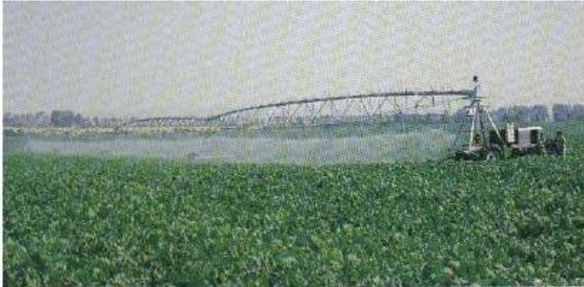
**Figure n° 18 : Ranger. Irrigation par avancement frontal**
