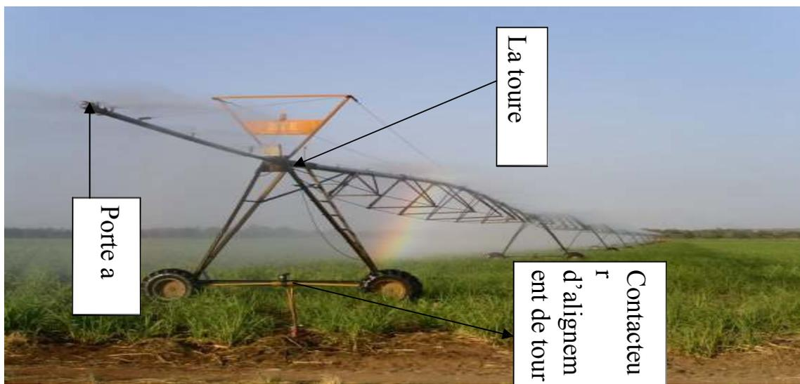
Figure IV .14. Description des éléments principaux du pivot
