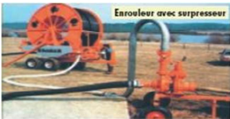
Figure IV .07. système d'aspersion avec enrouleur.
