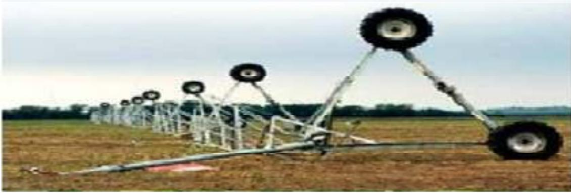
**Figure V -1:** Pivot renversé par le vent
