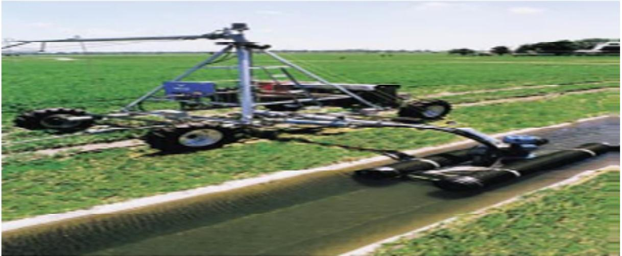
Figure IV .11.Rampe frontale universelle à alimentation par canal
