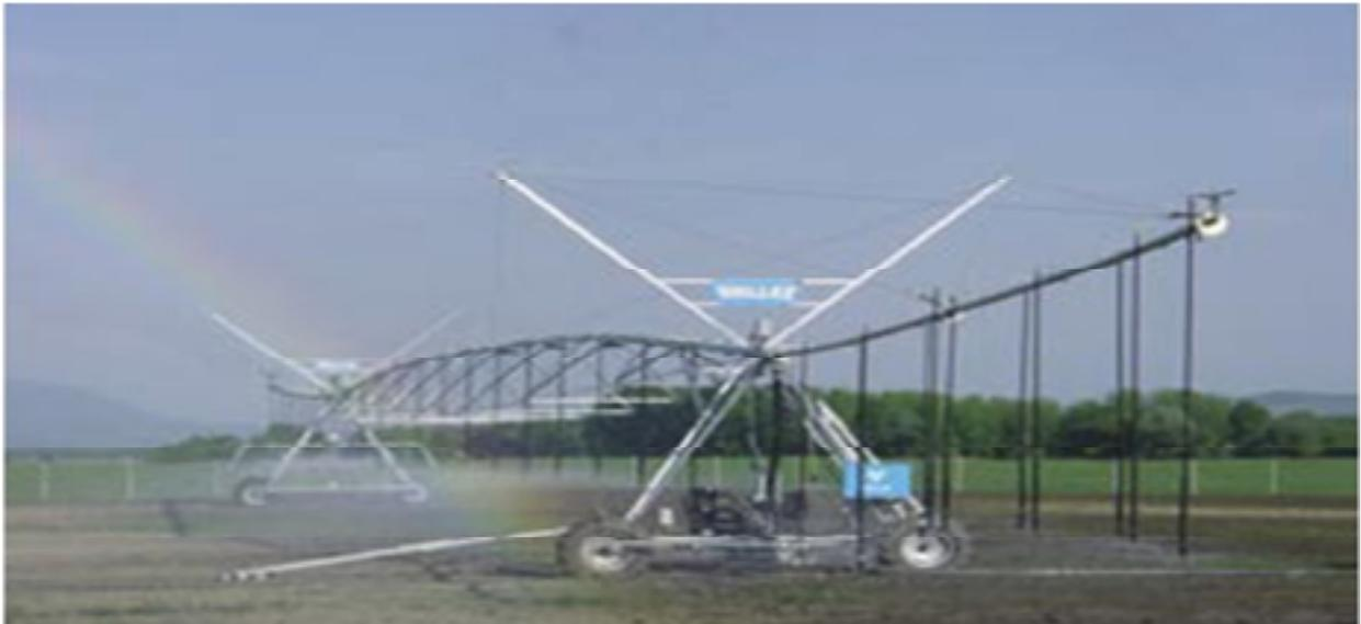
Figure IV .10. Rampe frontale à deux roues avec travée unique
