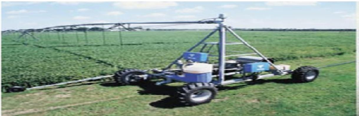
Figure IV.12. Rampe frontale universelle avec guidage par sillon
