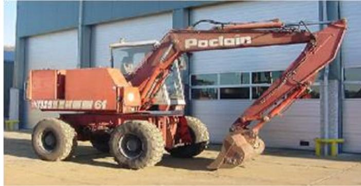
**Figure IX.7 : Pelle équipée en rétro**
