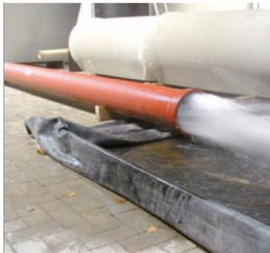
**Fig. V-3 : Test de nettoyage à haute pression (P = 200 bar).**
