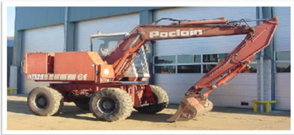
**Fig.VII.4**pelle équipée en rétro
