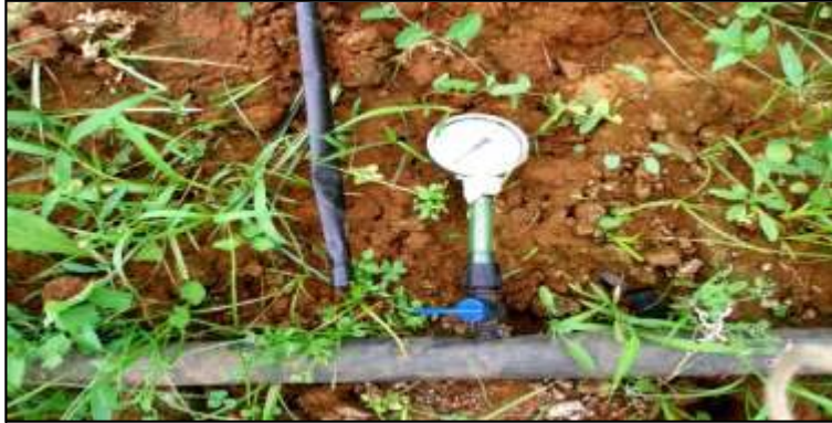
Figure IV-4: Mesure de pression à l'aide d'un manomètre.
