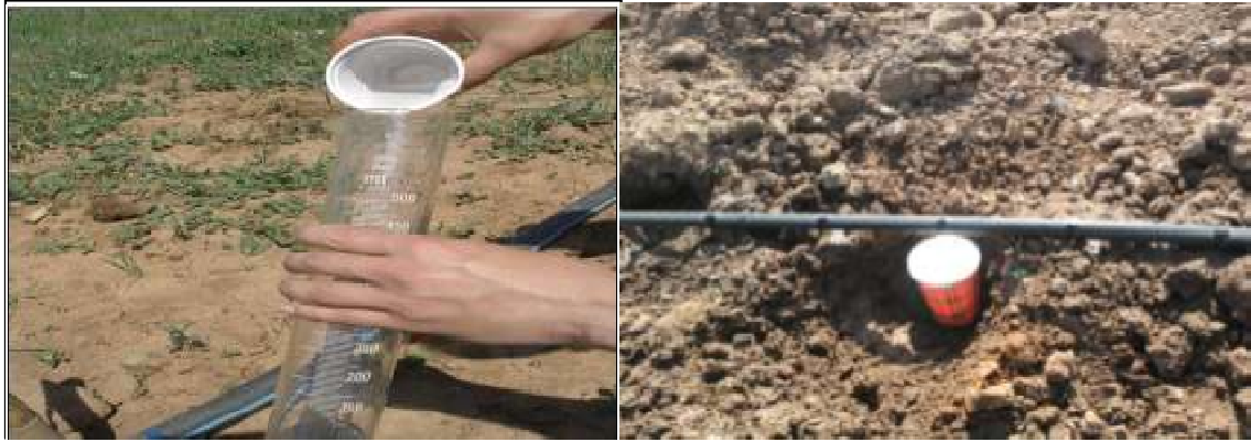
Figure IV-2: Mesures du débit des goutteurs.
