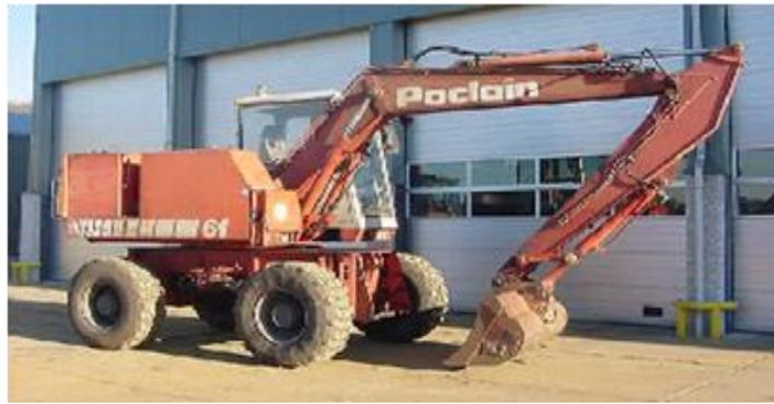
**Figure VIII.7 :** Pelle équipée en rétro source : (soidiki.centerblog.net)
