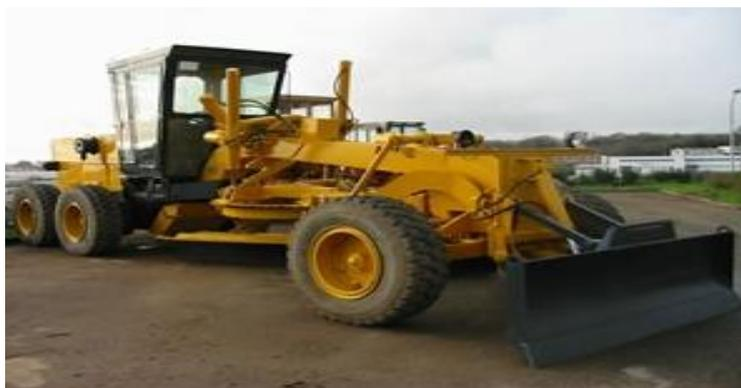
**Figure VIII.6 :** Niveleuse automotrice source : (soidiki.centerblog.net)
