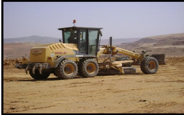
**Figure VIII-10 : Niveleuse automotrice**
