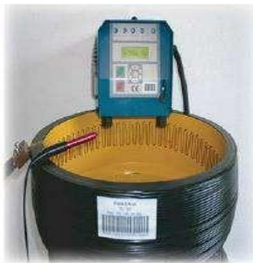
Figure VII-2 : Electro-fusion intégrée des tubes en PEHD
