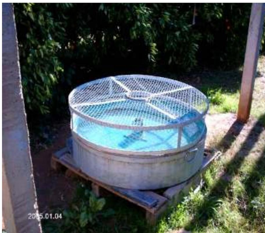
Figure II -2 : Photo d'un bac (class a) évaporant (2005)
